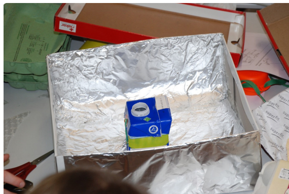
Abb. 10: Kalthaltebox mit innenliegender Spiegelfolie
